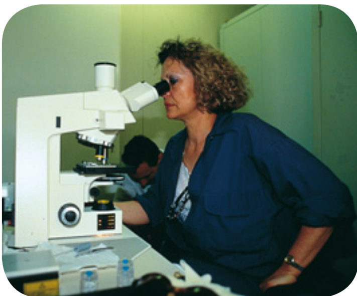
Le microscope optique à contraste de phase (MOCP) permet de compter les particules fibreuses collectées lors d'un prélèvement d'atmosphère.
