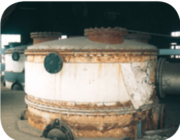
Calorifugeage sur un réacteur chimique.
