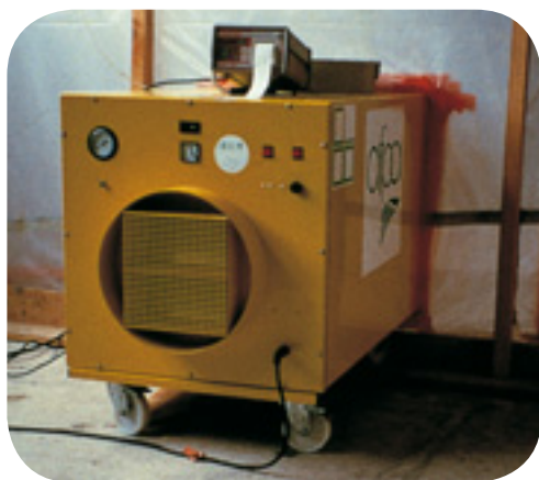
Extracteur d'air et système d'enregistrement.
